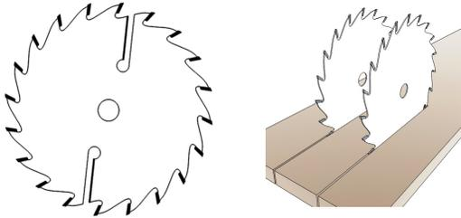
для продольной распиловки массива древесины вдоль волокон
