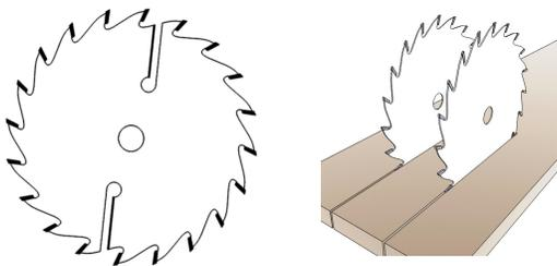
для продольной распиловки массива древесины вдоль волокон
